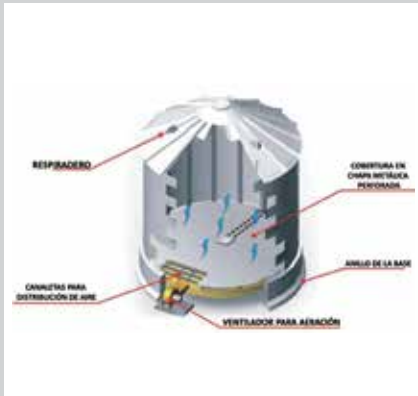
SISTEMA DE AIREACIÓN - SILOS PLANOS
