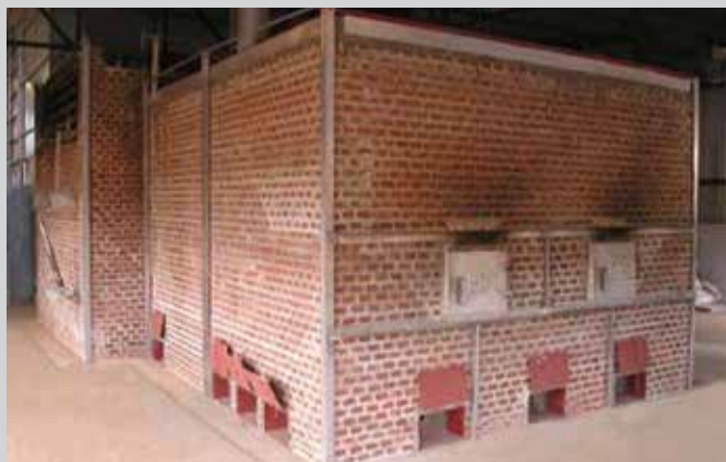
HORNO MANUAL DE MAMPOSTERÍA
