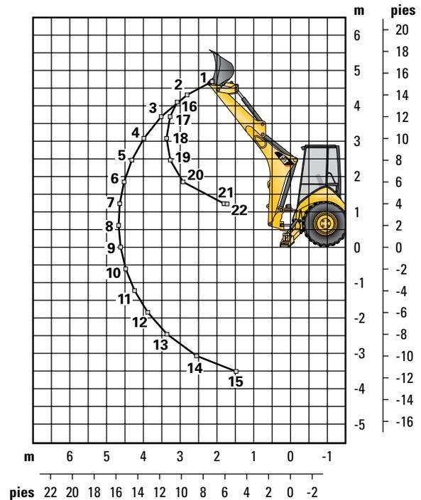
Las capacidades de levantamiento son valores de capacidad más allá del extremo de la máquina. Máquina equipada con tracción en las 4 ruedas, estructura OROPS, cucharón de uso general de 0,96 m³ (1,25 yd³) y sin contrapeso.
